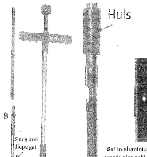
Gat in aluminium buizen wordt niet geblokkeerd door de stang met het diepe gat.
