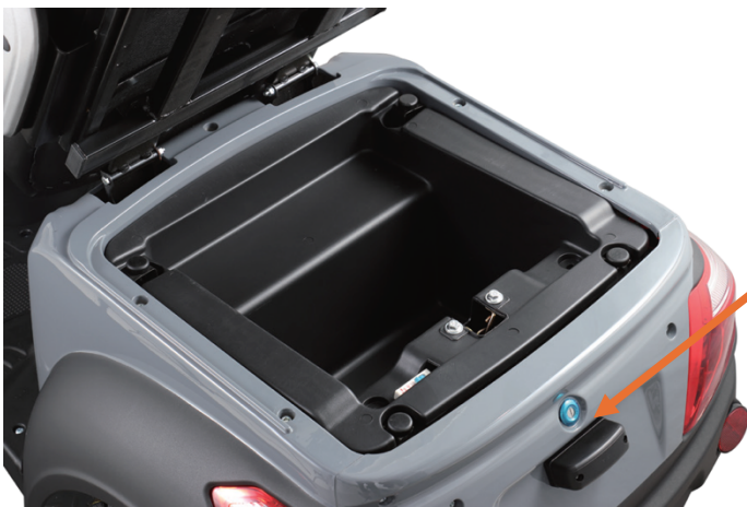
Abb. 1.10 Modelhafte Darstellung der Sitzverriegelung
