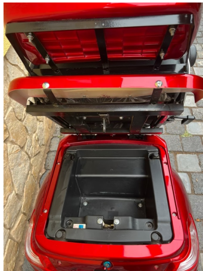
Abb. 1.12 Modelhafte Darstellung der Blei-Gel-Akku-Raum
