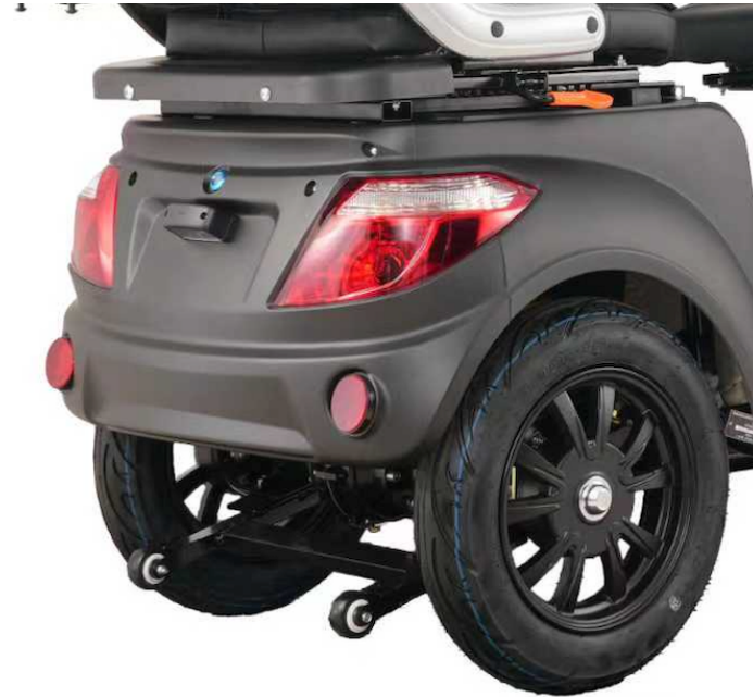
Abb. 1.11 Modelhafte Darstellung der Anti-tipp-/Stützräder
